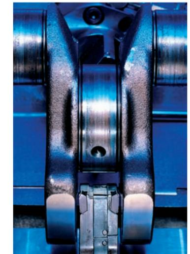
Kurbelwelle mit Messfühler und Glattwalzwerkzeug im Hintergrund
